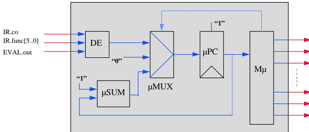
Las  $\mu$ instrucciones estan almacenadas en la M $\mu$ , la cual tiene una capacidad maxima de 64  $\mu$ instrucciones, con lo que el  $\mu$ PC tiene 6 bits.
