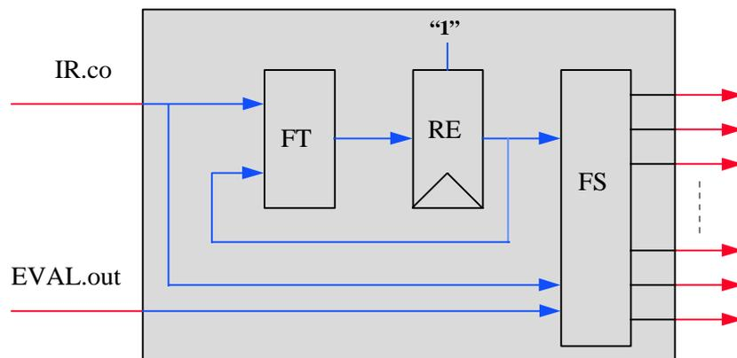
La **FT** genera el estado futuro a partir del estado actual y de la entrada correspondiente al código de operación. El **RE** almacena el estado de la U.C. La **FS** genera las señales de control a partir del estado actual, del código de operación y de la salida del evaluador de cero.
